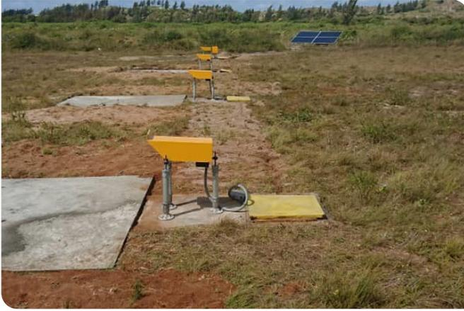
Indicateur de trajectoire d'approche de précision (PAPI) à LED d'Avlite, série 3, avec panneaux solaires en arrière-plan pour les installations de l'OACI.
