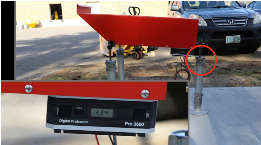
Inclinómetro posicionado en la parte superior del soporte del inclinómetro
