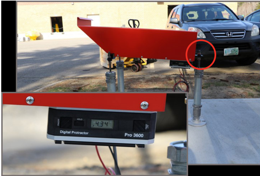
Inclinomètre positionné au-dessus du support de l'inclinomètre
