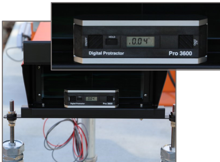
Inclinômetro posicionado no meio da frente da placa de base
