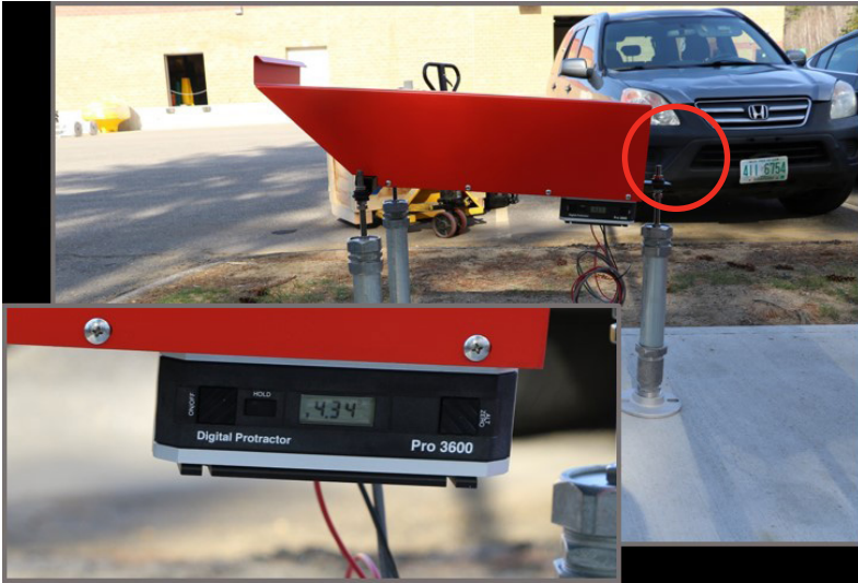
Inclinômetro posicionado sobre o suporte do inclinômetro
