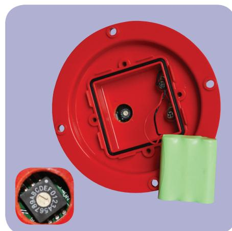
Los códigos de ritmos se seleccionan mediante un interruptor interno localizado en el interior de la batería
