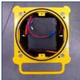
1. Desatornille los 4 tornillos de cabeza allen y desconecte el cabezal del chasis.
